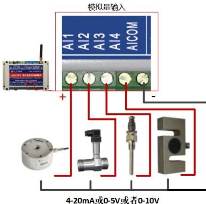
模拟量输入用来检测电压或电流信号，比如温度，压力、流量等传感器的模拟量输入信号。连线的示意图如上图所示，连接时请注意信号的正负极。模拟量输入的量程可设定为 4-20mA 或 0-5V 或者 0-10V，具有过压防反接保护。量程需要在订货时提前声明，默认量程为 4-20mA。
